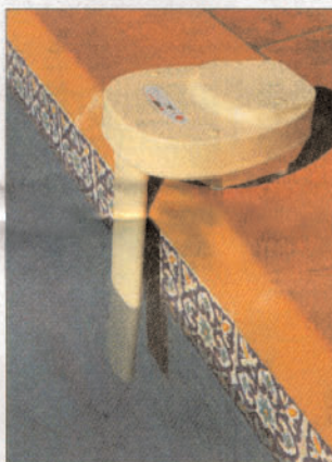
Le détecteur fabriqué par MGI. L'alarme se déclenche lorsque quelqu'un tombe dans la piscine. DR
